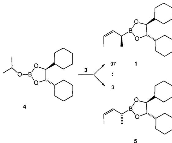
halten wurde. Dieser wurde durch Reaktion von **1** mit Benzaldehyd und Bestimmung der Enantiomerenreinheit des Alkohols **2** ermittelt. Das dem Borat **4** zugrundeliegende Glycol und damit auch **1** sind in beiden enantiomeren Formen leicht zugänglich<sup>[2, 9]</sup>.
